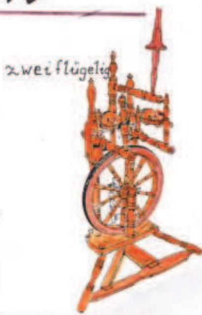
Das Prinzip des Spinnens ist: die einzelnen Flachsfasern (oder Wollhaare) zu einem gleichmäßig starken Faden von durchgehender Länge zusammenzudrehen.
